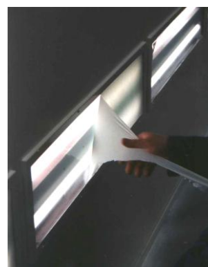
Удаление затвердевшего покрытия
